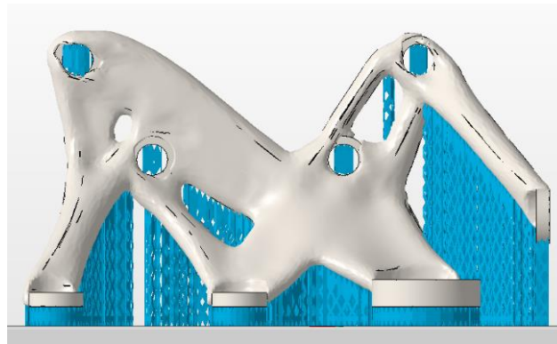
Figura 45 - Suportes gerados: Perspetiva_1 (Netfabb).
